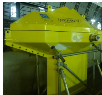
Figure 1 : prototype du SEAREV à l'échelle 1 : 12
