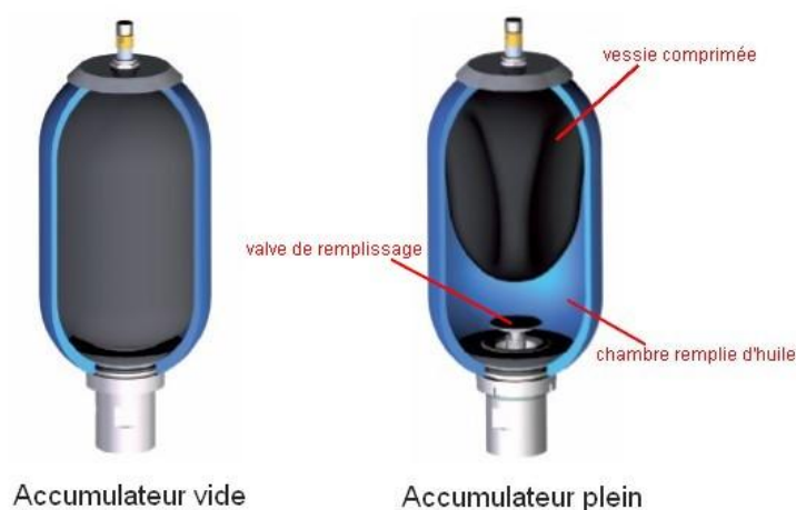
Figure 10 : états de fonctionnement d'un accumulateur hydraulique
