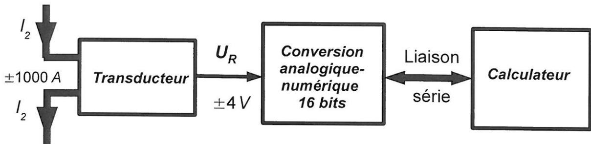
Figure 13 : chaîne d'acquisition du courant  $I_2$
