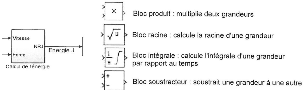
Figure 7 : blocs disponibles pour réaliser la fonction calcul de l'énergie
