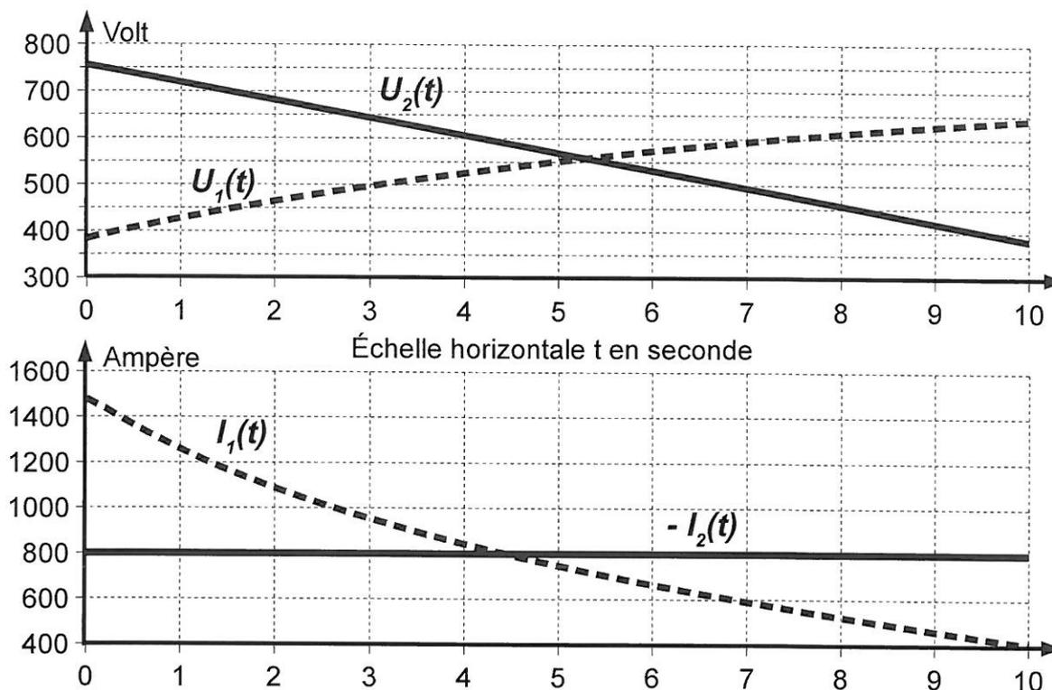
Figure 10 : résultat de la simulation, évolution de  $U_2(t)$ , de  $U_1(t)$ , de  $-I_2(t)$  et de  $I_1(t)$
