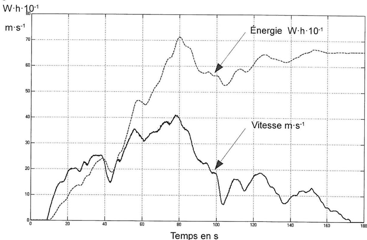
Figure 6 : vitesse et énergie motrice du bus en fonction du temps obtenues à partir du modèle
