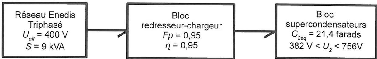
Figure 11 : chaîne d'énergie du chargeur dans la borne
