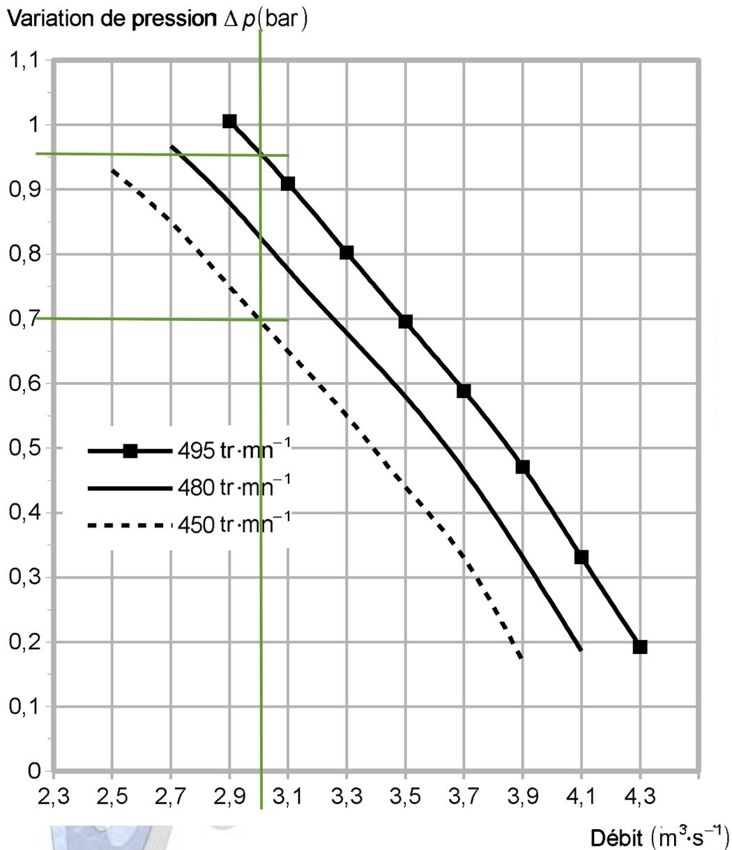
**Q10.** Calculer la valeur de la puissance  $P_{HU}$  pour un débit de  $3 \text{ m}^3 \cdot \text{s}^{-1}$  ainsi que le rendement global de la solution avec variateur et la puissance fournie par le réseau électrique  $P_R$
