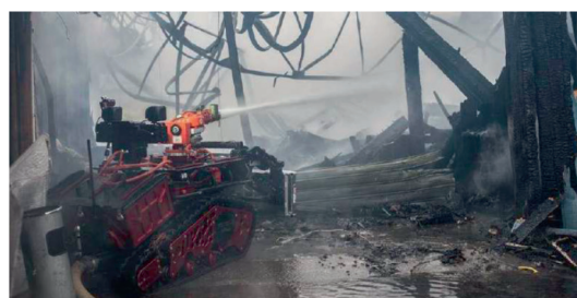
Figure 7 : Colossus version canon à eau + tourelle vidéo
