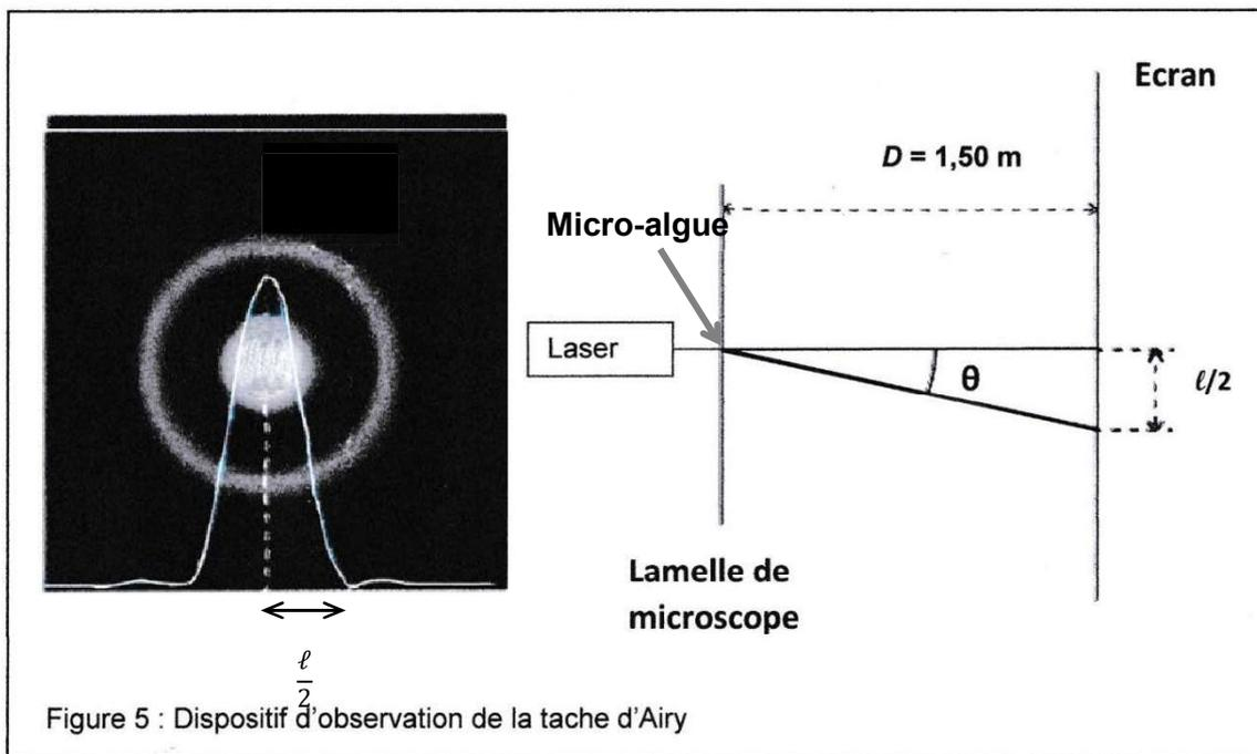
4. Établir la relation qui donne le diamètre  $d$  de la micro-algue en fonction de la longueur d'onde  $\lambda_v$  du laser, la largeur  $\ell$  de la tache centrale et de la distance  $D$  entre la lamelle de microscope et l'écran, sachant que  $\ell$  est très inférieur à  $D$ .
