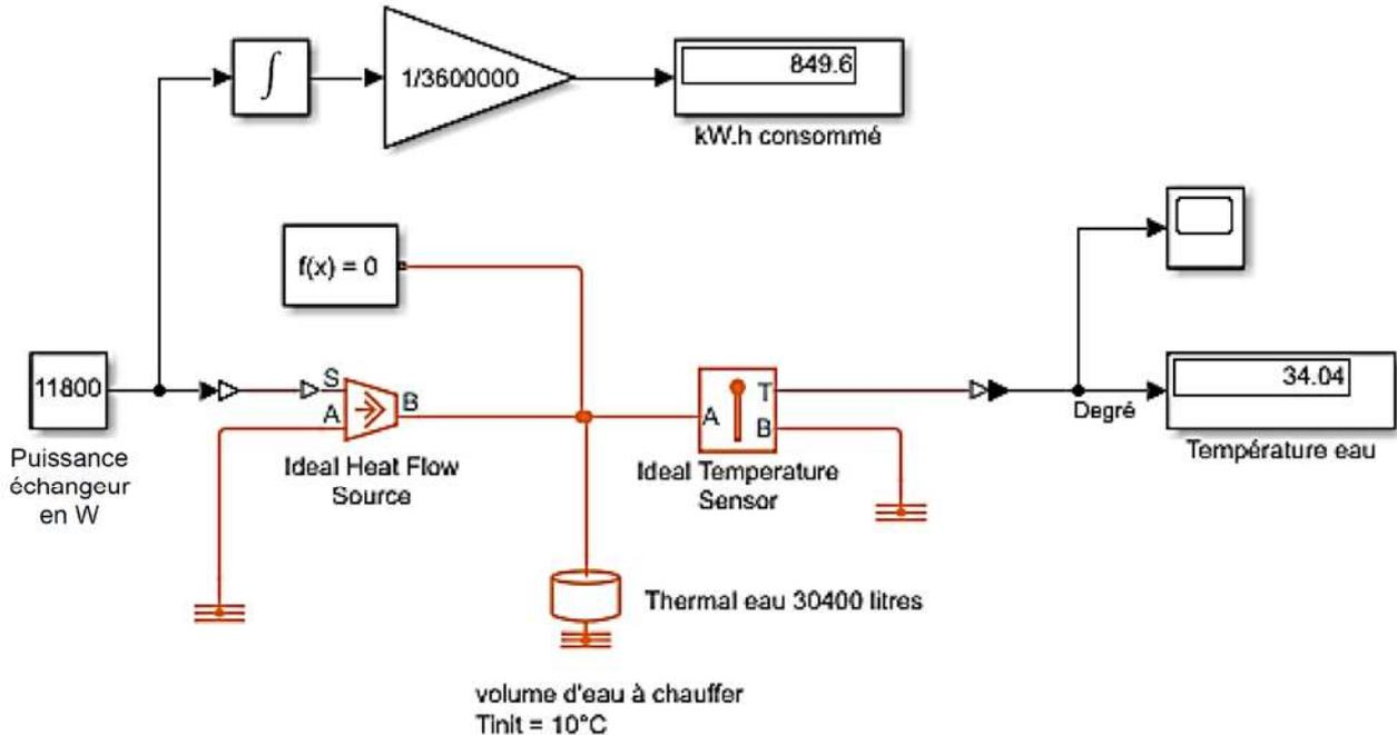
figure 6 - Modèle multi-physique de montée en température ;
