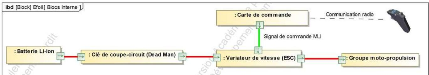
figure 14 - Diagramme de blocs interne simplifié
