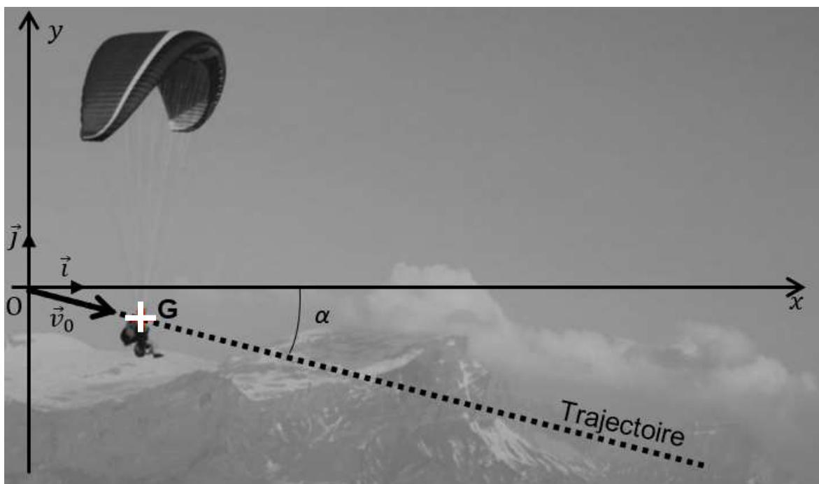
Figure 1. Pointage des positions du centre de masse G du système {pilote + parapente} au cours d'un vol droit équilibré.
