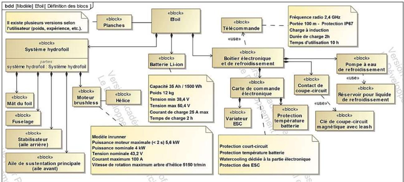
figure 8 - Diagramme de définition des blocs
