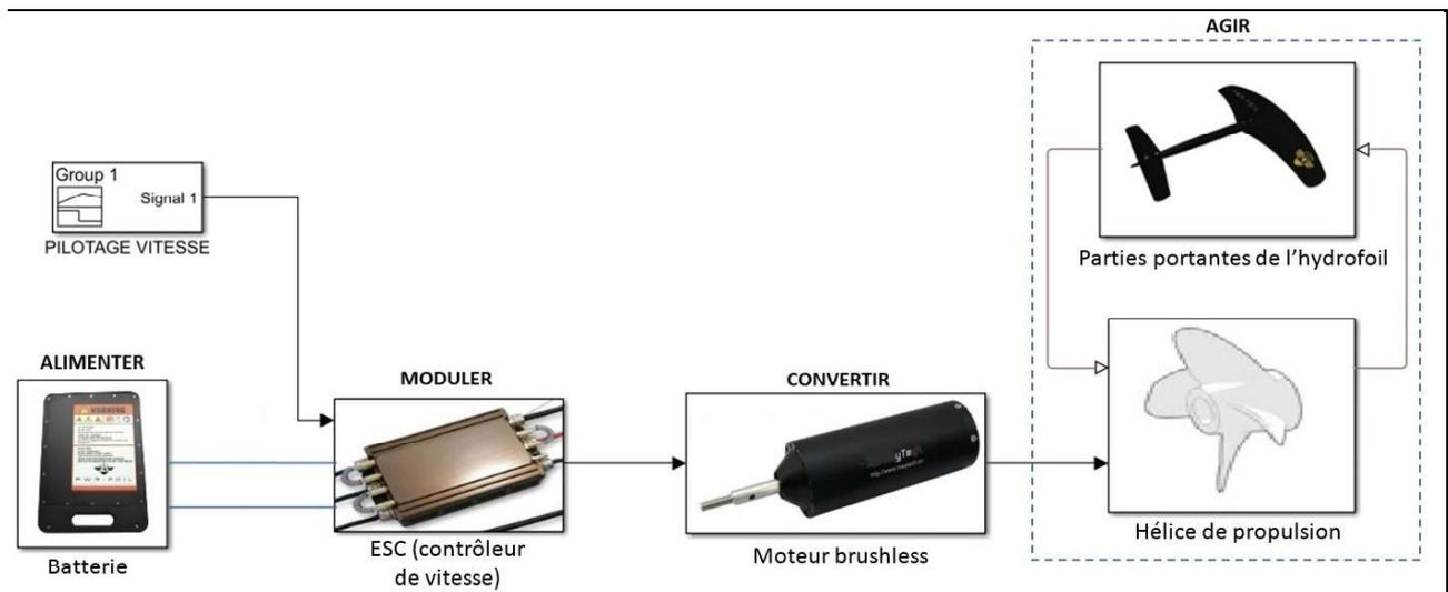
figure 7 - Modèle multiphysique
