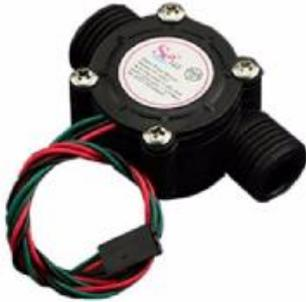
Le capteur de débit est constitué d'un rotor et d'un capteur à effet hall. Lorsque le liquide passe dans le capteur, le rotor génère des impulsions en fonction du débit. La fréquence de sortie varie en fonction de la vitesse du rotor. En connaissant le diamètre du tuyau, il est possible de calculer la vitesse du liquide.
