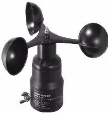
L'anémomètre est constitué d'un rotor et d'un capteur à effet hall. Lorsque le vent frappe les coupelles demi-sphériques, le rotor génère des impulsions en fonction de sa vitesse de rotation. La fréquence des impulsions est donc directement liée à la vitesse du vent.
